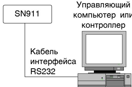
Рис.1 Установка и соединение приемника.
