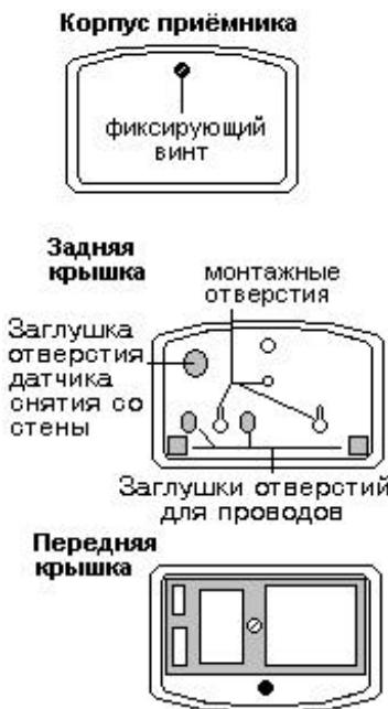
Рис.2 Корпус приемника
